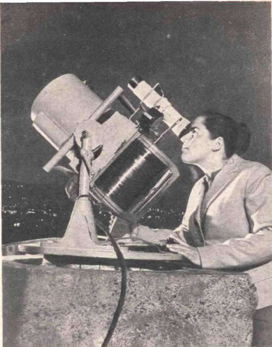
Дозорные на посту. Ира Швалагин нацелила объектив своей фотокамеры в небо, где вот-вот должна появиться стремительно летящая звездочка. Зафиксированный на фотопленке след спутника среди звезд позволяет определять его положение и орбиту гораздо точнее, чем при визуальных наблюдениях.
